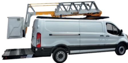
Nacelle à échelle RH 38' isolée avec accès au sol
