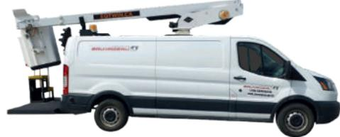
Nacelle à mât télescopique isolé Versalift 36'
