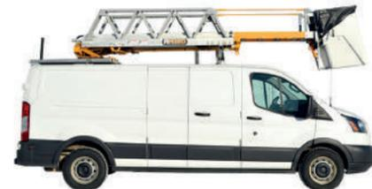
Nacelle à échelle RH 37' non-isolée ou RH 38' isolée
